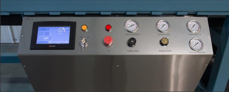
El panel de control contiene la pantalla táctil, los ajustes para la presión de desplazamiento de la unidad, la velocidad de desplazamiento de la unidad y la velocidad de rotación del cabezal de bruñido. El panel de control también incluye indicadores para los diferentes ajustes, incluida la
